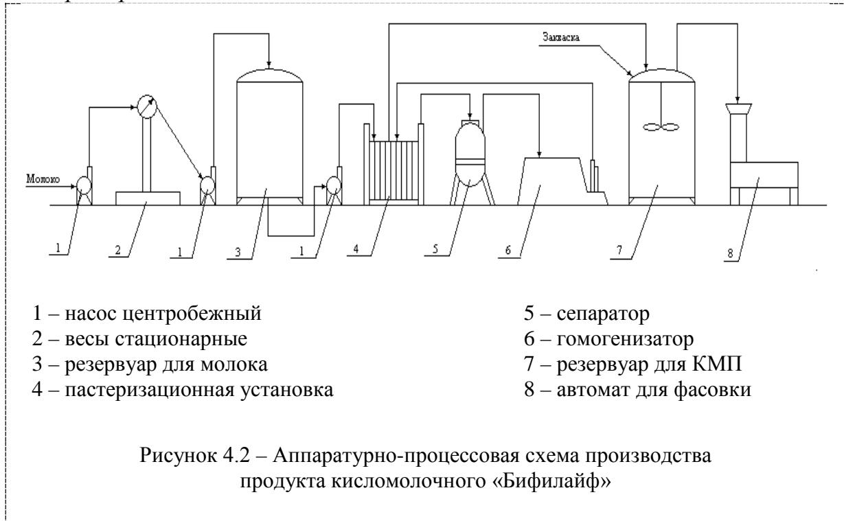
Рисунок 4.2 – Аппаратурно-процессовая схема производства продукта кисломолочного «Бифилайф»
